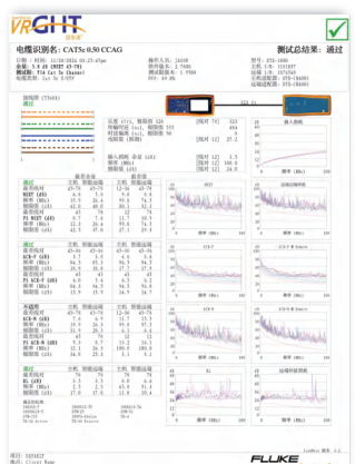
超五类0.50高导电铝导体通过福禄克测试/ FLUKE
